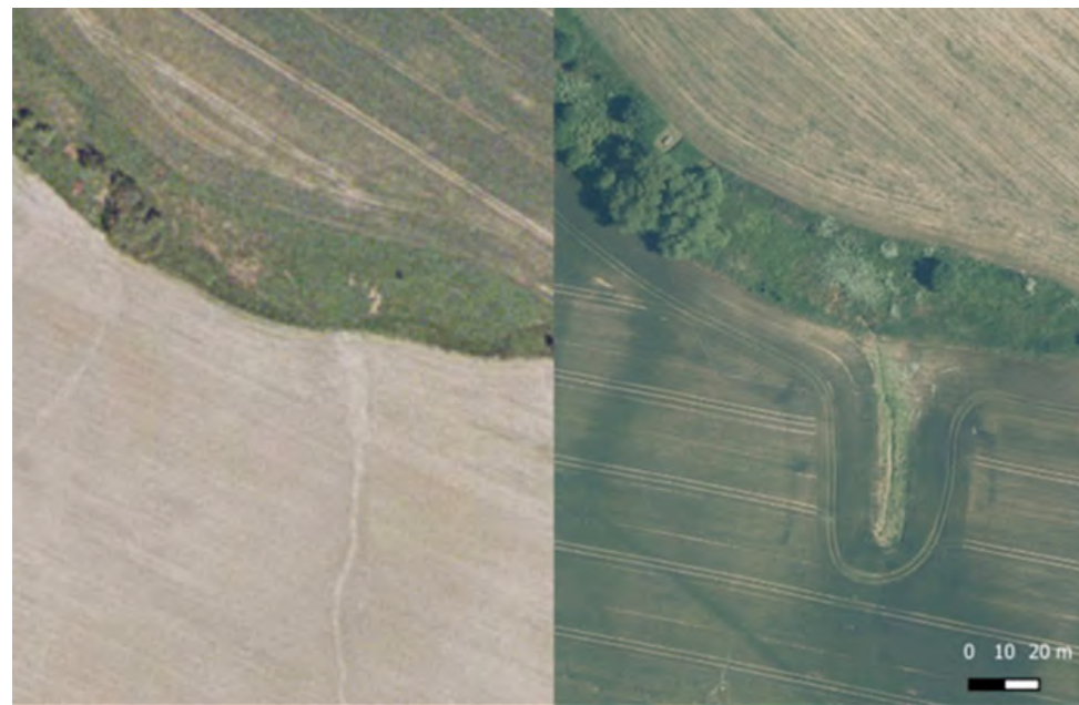
Obrázek č. 61: Místo s rozpadajícím se sběrným potrubím. Vlevo je rok 2006, vpravo rok 2022. (Podkladová data: Prohlížeč služba WMS – Ortofoto, ČÚZK, 2023)
