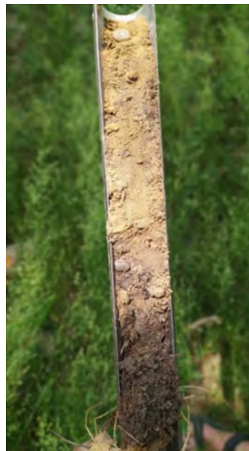
Obrázek č. 46: Detaily sondovací tyče se zrnitostně lehkým (písčitým) materiálem okrajů propasti – zde vzniká půdní typ regozem.
