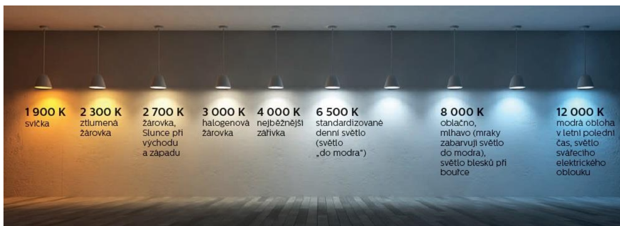
Obrázek č. 5.3 – chromatické teploty světelných zdrojů umělého osvětlení – zdroj www.svet-svitidel.cz
