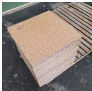
Obr. 1: Trojvrstvová drevotriesková doska s prídavkom plastu v stredovej vrstve 10 %
