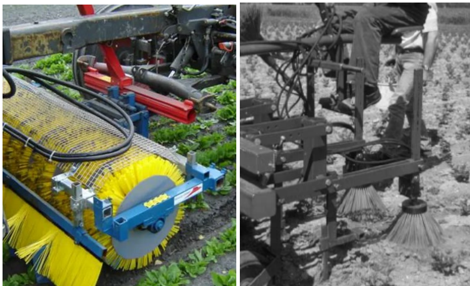
Obr. 2.11 Dva hlavní typy kartáčových pleček. Vlevo kartáčová plečka s horizontální osou otáčení a vpravo kartáčová plečka s vertikální osou otáčení.
