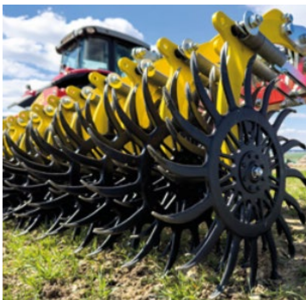
Obr. 2.8 Dva hlavní typy hvězdicových plecích bran. Vlevo hvězdicové brány s pružnými pruty, u nichž je agresivita pletí nastavována úhlem vůči směru jízdy. Větší odklon vůči směru jízdy znamená vyšší agresivitu pletí. Vpravo hvězdicové brány s pevnými a jedním směrem zahnutými paprsky. Agresivita pletí je zajišťována otočením paprsků po směru nebo proti směru jízdy.
