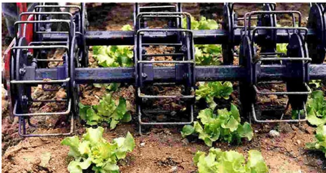
Obr. 2.12 Košíková plečka. První osa slouží jako hnací a válcové klece narušují rovněž povrch půdy. Zadní osa se otáčí rychleji a válcové klece kypří půdu a ničí plevely.
