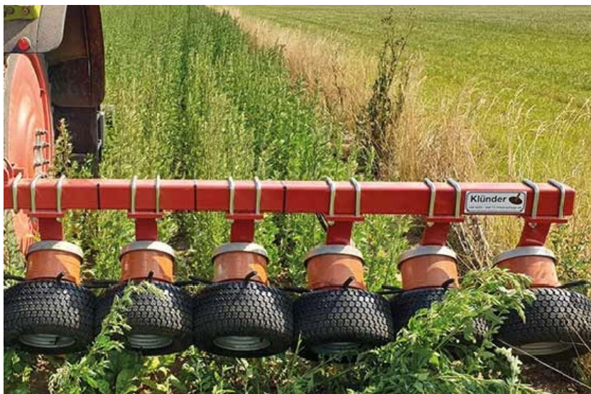
Obr. 2.15 Vytrhávač velkých plevelů na principu poháněných protiběžných pneumatik
