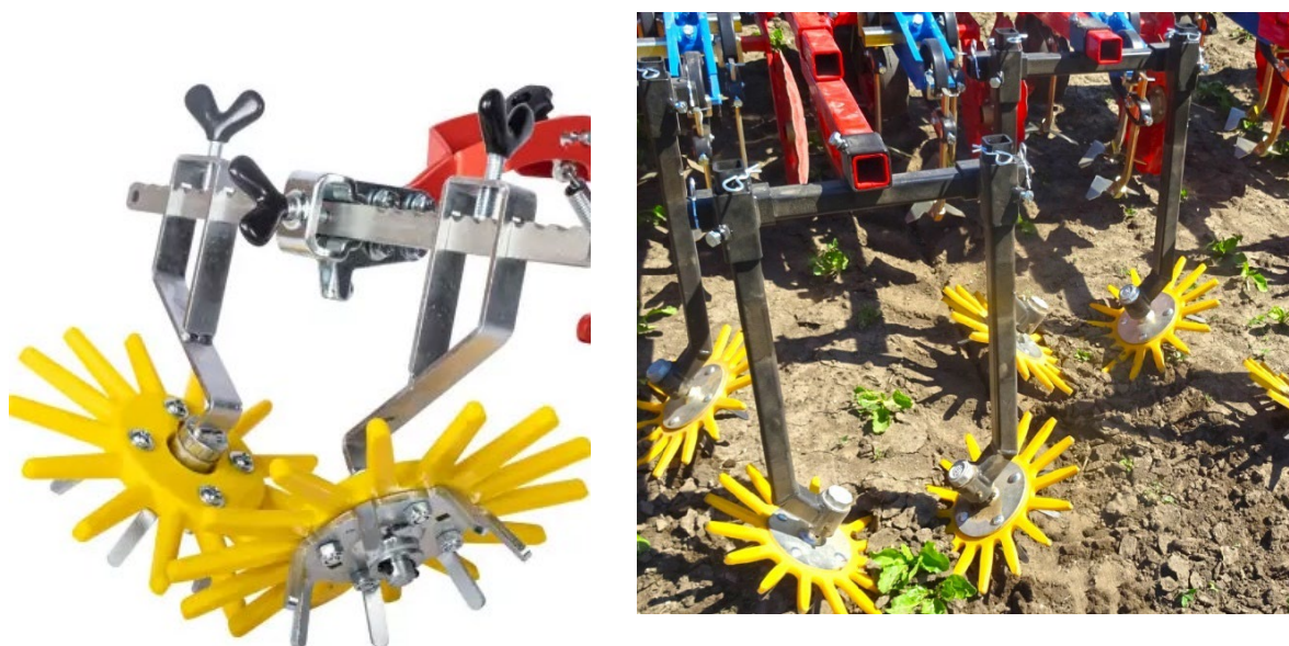
Obr. 2.13 Jednotka prstové plečky pro jeden řádek (vlevo) a prstová plečka při práci v řádku cukrovky (vpravo). Vzdálenost mezi plastovými prsty je nastavitelná a zajišťuje tak intenzitu kypření v řádku. Pohyb kotoučů je zajišťován kotouči s ocelovými hroty, které zasahují hlouběji do půdy.
