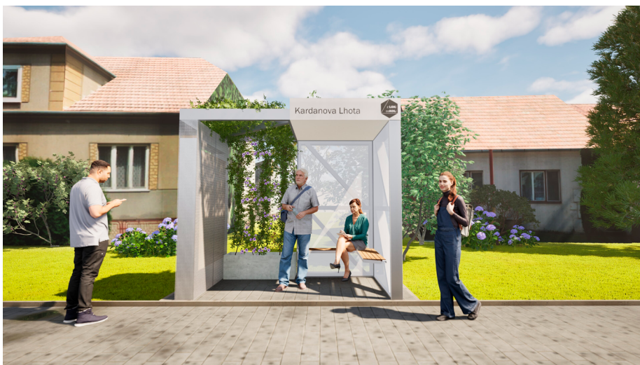
2: Bioklimatický mobiliář ve veřejném prostoru venkovského sídla. Příklad autobusové zastávky ve variantě „Míni“, se zachováním všech funkcí BK opatření: panel s adiabatickým chlazením, vertikální zeleň, bílá barevnost, proudění vzduchu, redukce solárních zisků. Návrh a vizualizace: Atelier Dohnalovi, 2025.
